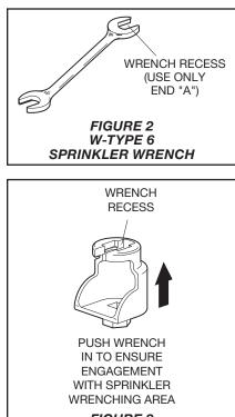
FIGURE 3 W-TYPE 7 RECESSED SPRINKLER WRENCH
